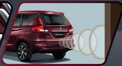
เซ็นเซอร์ถอยหลังพร้อมสัญญาณเตือน มั่นใจปลอดภัย ช่วยให้ผู้ขับขี่กะระยะถอยหลังได้อย่างแม่นยำ
